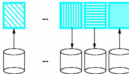
Mehrere unabhängige E/A-Aufträge können parallel ausgeführt werden, sofern die betreffenden Daten über verschiedene Platten verteilt sind
