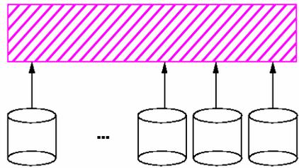
1 E/A-Auftrag wird in mehrere, parallel ausführbare Plattenzugriffe umgesetzt
